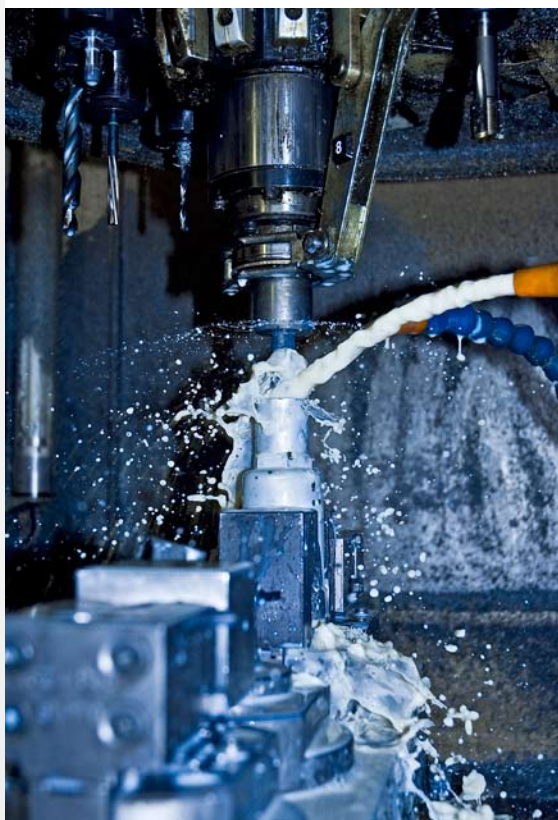
Kuva tuotannostamme. Yllä paineilmatoimisen 5:1 pumpun sylinterin lastuavaa työstöä valmistuskeskuksessamme.
