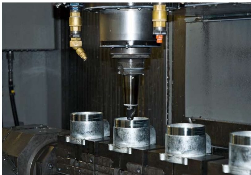
Kuva tuotannostamme. Yllä paineilmatoimisen 5:1 pumpun sylinterin lastuavaa työstöä valmistuskeskuksessamme.
